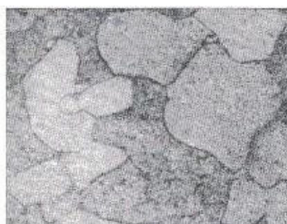
Техническое железо; зерна феррита с ясным очертанием их границ. Травление 4%-ным раствором HN в спирте
