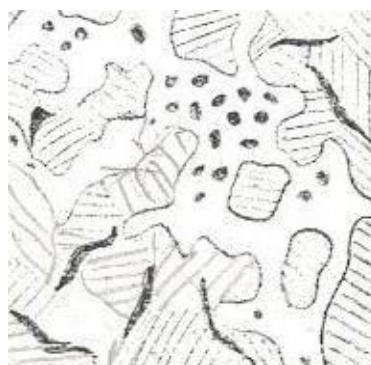
Рис. 6- Половинчатый чугун – ледебурит + пластинчатый графит: а – микроструктура, б – схема микроструктуры.
