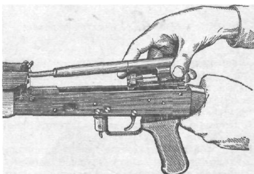
Присоединение затворной рамы с затвором
