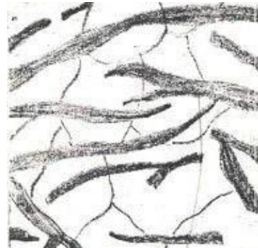
Рис. 1- Ферритный серый чугун – феррит + пластинчатый графит:
