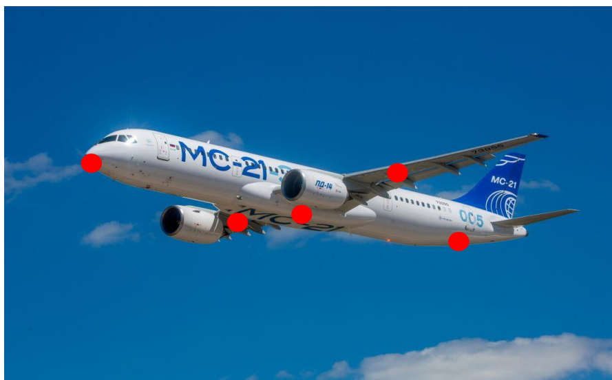
Рис. 1. Места расположения датчиков ускорений (Fig. 1. Acceleration sensor locations)
