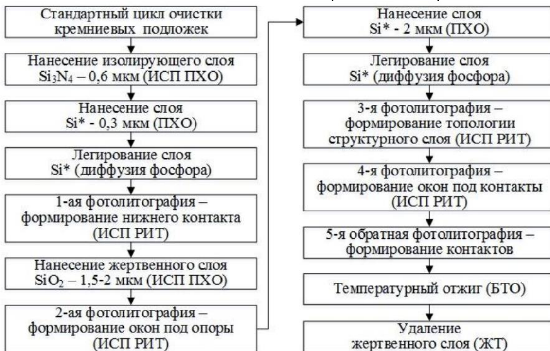
Рис. 3. Процесс создания микромеханического акселерометра (ММА) на подложке [2]
