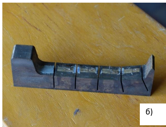
Рис. 2. Вырезанные фрагменты обода колеса с тензорезисторами: а – продольными; б – поперечными
