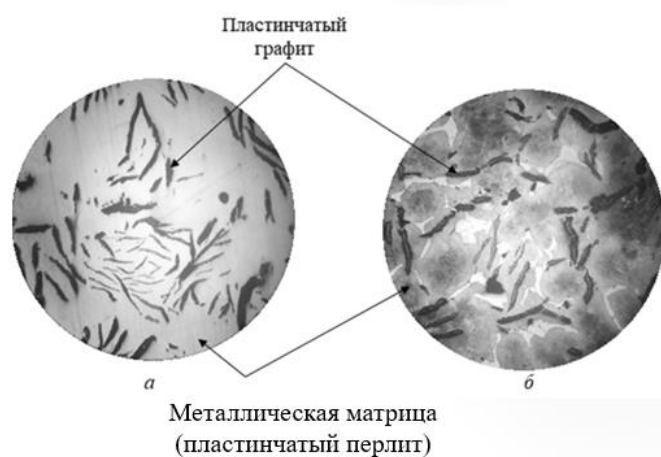
Рис.1. Микроструктура чугуна до (а) и после (б) травления, x100
