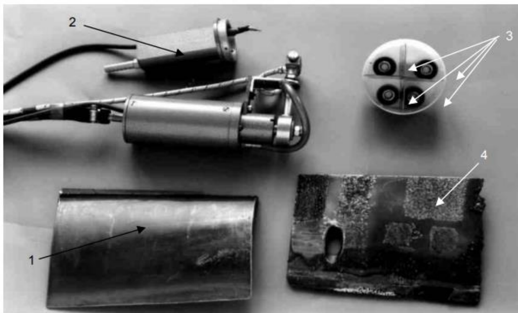
Рис.2. Внешний вид электромеханического вибратора: 1 – вибратор без съемной рукоятки; 2 – съемная рукоятка; 3 – сменные эксцентрики; 4 – образец формируемого покрытия
