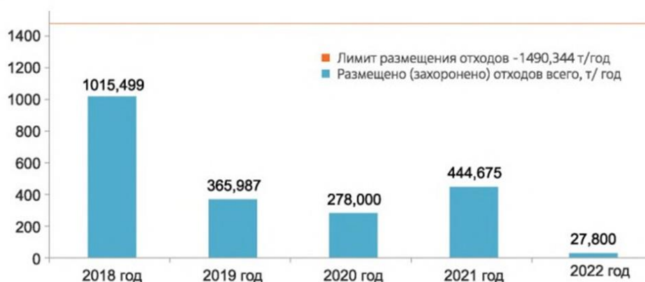
Диаграмма 5. Динамика размещения (захоронения) отходов производства и потребления Смоленской АЭС за последние пять лет
