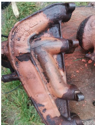
Рис.1. Усталостная трещина на детали
