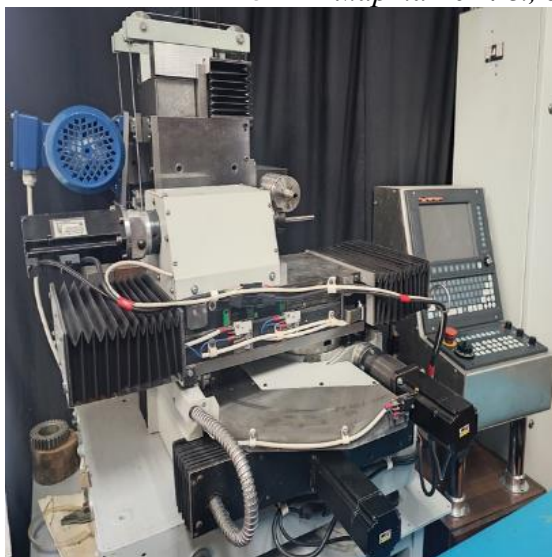
Рис. 3. Общий вид шлифовально-заточного станка с ЧПУ
