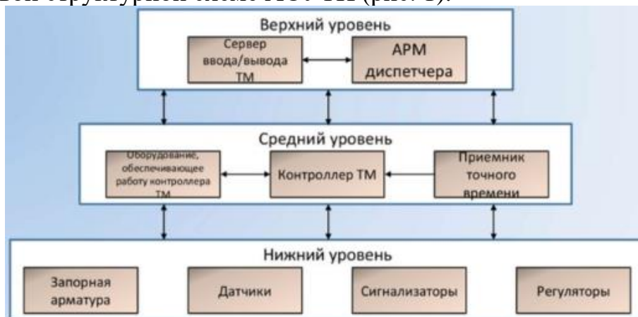
Рис. 1. Трёхуровневая схема АСУТП: АРМ – автоматизированное рабочее место; ТМ – телемеханика
