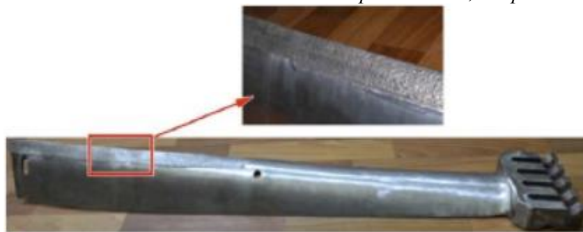
Рис.6. Внешний вид лопатки паровой турбины с покрытием из стеллита ВЗК
