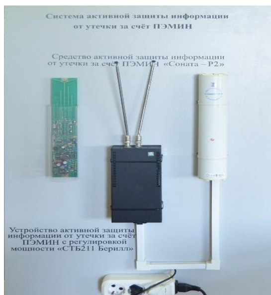
Рис. 2. Стенд системы активной защиты информации от утечки за счёт ПЭМИН
