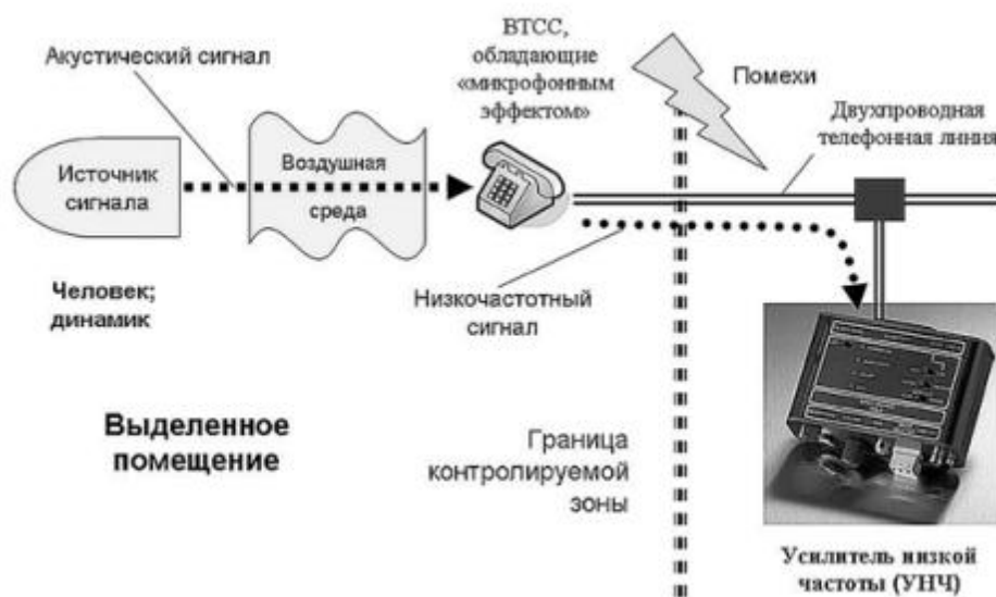
Рис. 1. Схема утечки акустической информации за счет подслушивающих устройств
