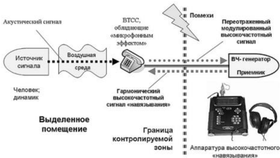
Рис. 2. Схема утечки акустической информации с помощью ВЧ-навязывания
