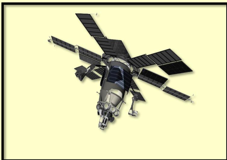
Молния-3 (индекс ГРАУ: 11Ф637) - советский, спутник связи двойного назначения, КГБ СССР и МО СССР, разработанный НПО ПМ. Как и его предшественник КА «Молния-2», построен на базе спутниковой платформы КАУР-2 и являлся частью Единой системы спутниковой связи (ЕССС) вместе с КА Радуга («Грань») и КА
