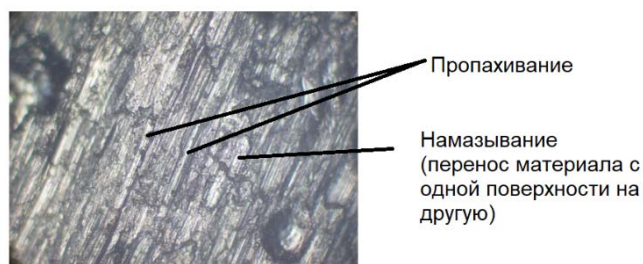
Рисунок – 13. Микрофотографии стальной поверхности трения после приработки без магнитного поля по схеме «палец – диск» (x125)
